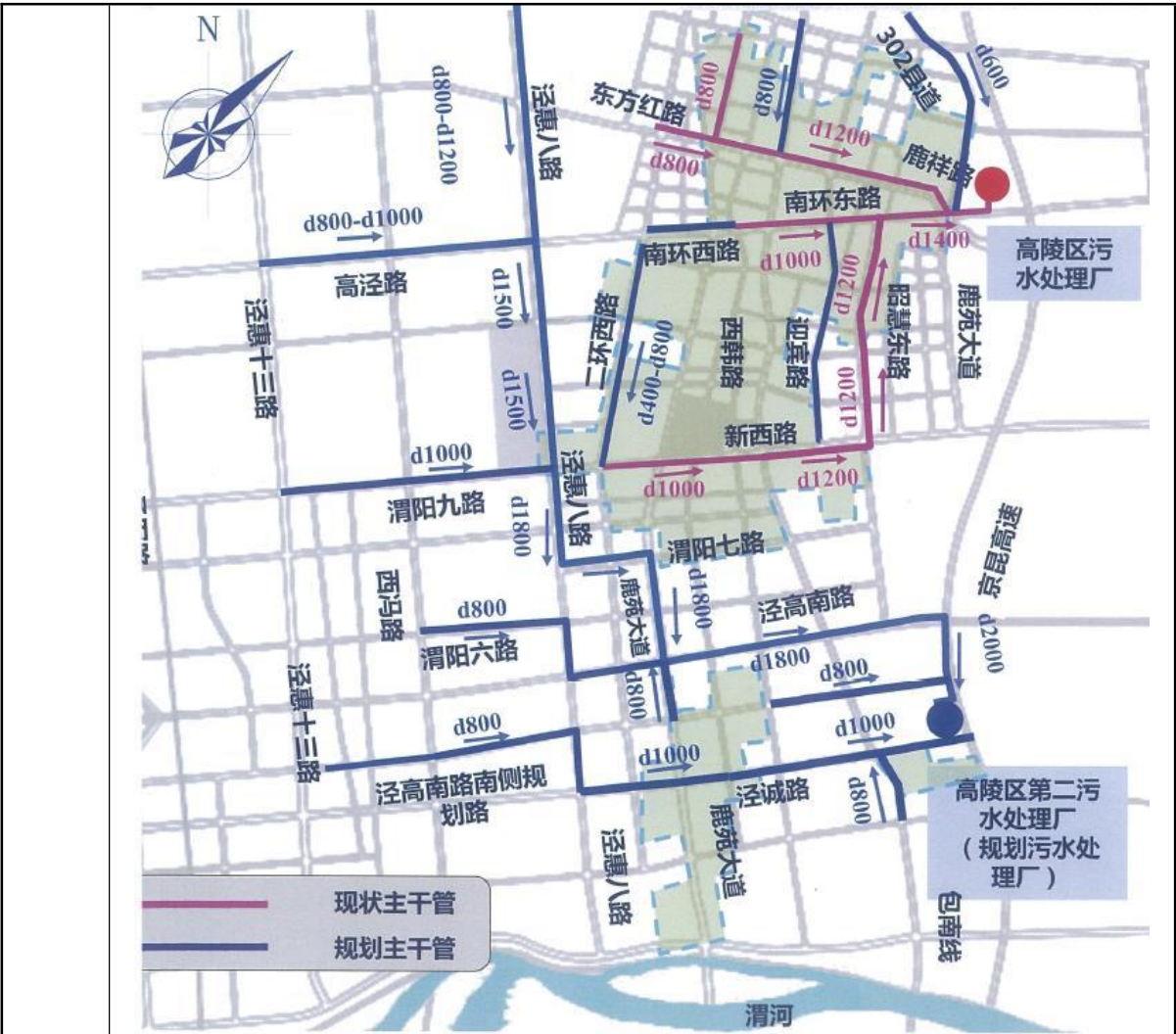
图 2-1 高陵区污水处理厂收水管网范围图
